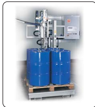
Estação de enchimento - tipo 17
